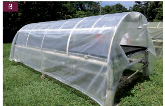
Figura 1. Secadores solares tipo túnel. Con plástico Agroplast N (A); Malla plastificada Europlast (B).
