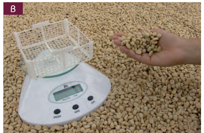
Figura 2. Disposición del café en el secador. Rastrillo utilizado para revolver (A); Canastilla empleada con el método Gravimet (B).
