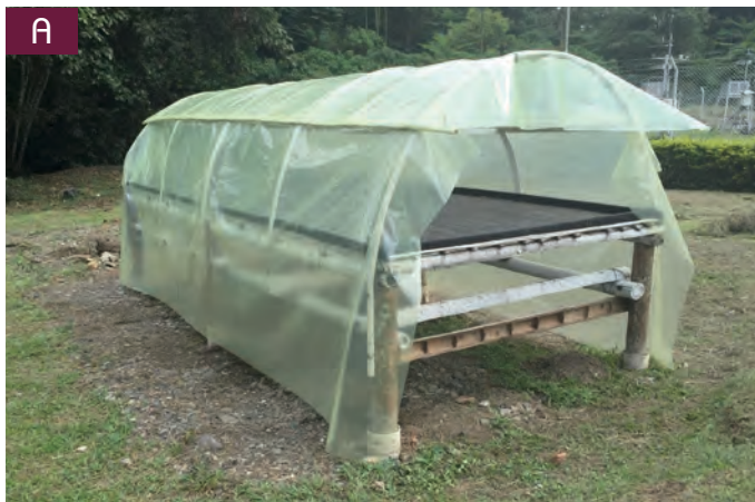
Figura 1. Secadores solares tipo túnel. Con plástico Agroplast N (A); Malla plastificada Europlast (B).
