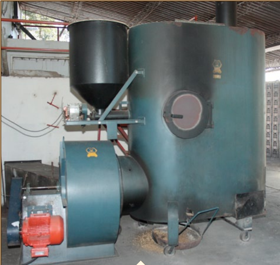
Figura 4. Intercambiador de calor para secado de café.
