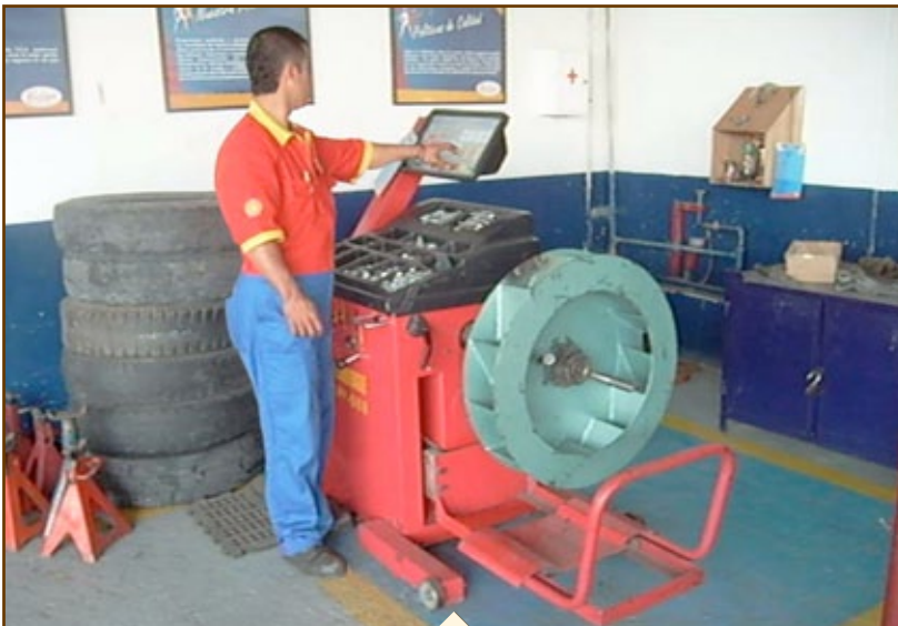
Figura 19. Balanceo de rotor del ventilador en máquina utilizada para ruedas de camiones.
