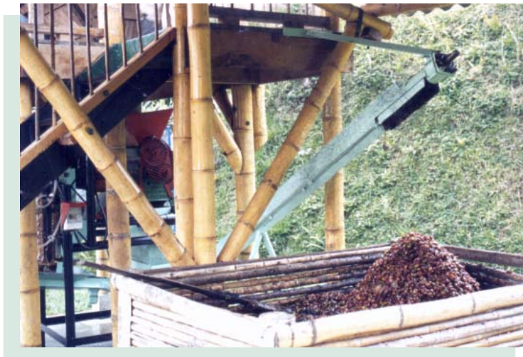
Transporte de la pulpa mediante un tornillo sinfín
