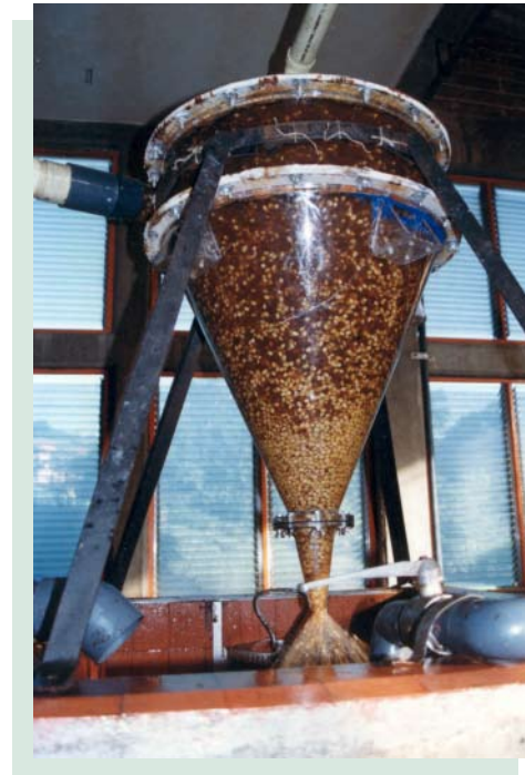
Descarga de granos buenos por el hidrociclón
