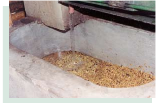
Adición de agua segundo y tercer enjuague
