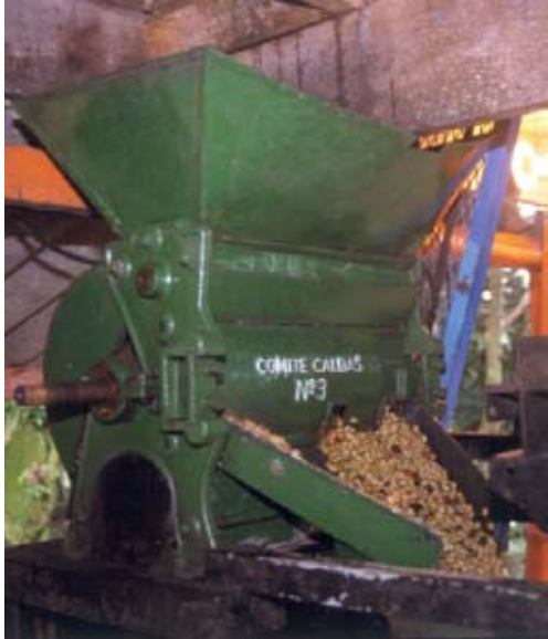
Despulpado del café sin agua
