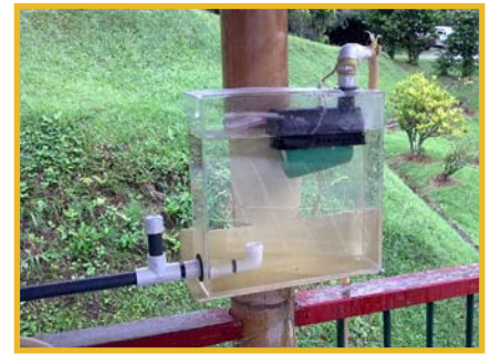
Figura 7. Sistema de placa de orificio calibrada, instalada en un módulo Becolsub 300.
