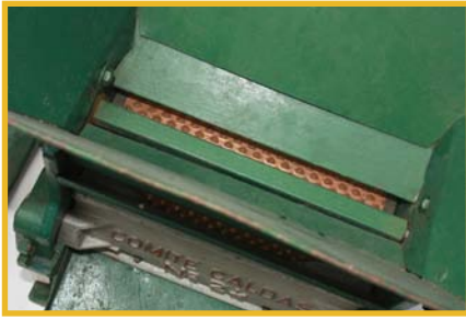
Figura 1. Despulpadora tradicional con dosificador de eje cuadrado y cuchillas.
