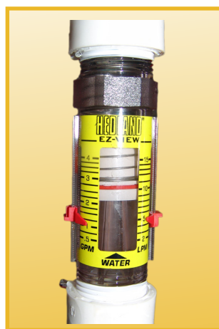
Figura 8. Rotámetro instalado en una tubería.
