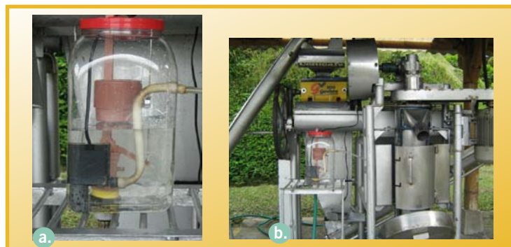
Figura 5. Arreglo con flotador y motobomba sumergible para suministrar constantemente agua a desmucilaginos Deslim.
