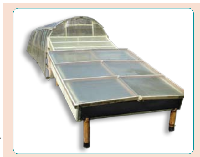
Figura 8. Secador tipo túnel con colector solar.
