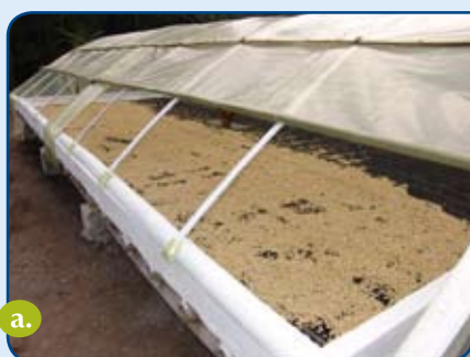
Figura 8. Operación del secador parabólico solar reformado. a). Inicio del secado; b). Etapa final de secado; c) Recogida del café al final del día.
