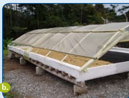
Figura 8. Operación del secador parabólico solar reformado. a). Inicio del secado; b). Etapa final de secado; c) Recogida del café al final del día.
