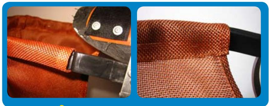
**Figura 7.** Detalles de la unión de la manga al aro.
