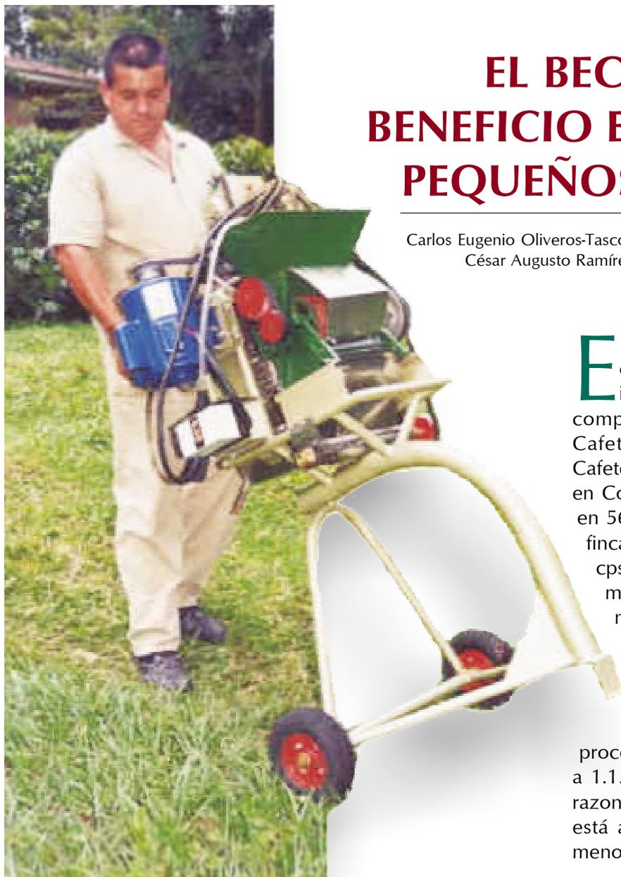
El módulo BECOLSUB 100 (Figura 1), ofrece en una escala de procesamiento menor (100kg de cereza/h) todas las ventajas técnicas y ecológicas de los equipos 300, 600, 1.000 y 3.000. En su diseño se tuvo en cuenta lo siguiente:
