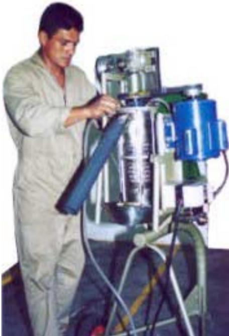
Figura 1. Módulo BECOLSUB 100 diseñado por Cenicafé
