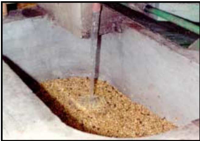
Figura 4. Primera adición de agua a la masa fermentada.
