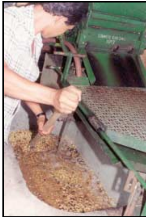
Figura 5. Agitación de la masa en el primer enjuague (I) hasta que la masa fluye (despega).
