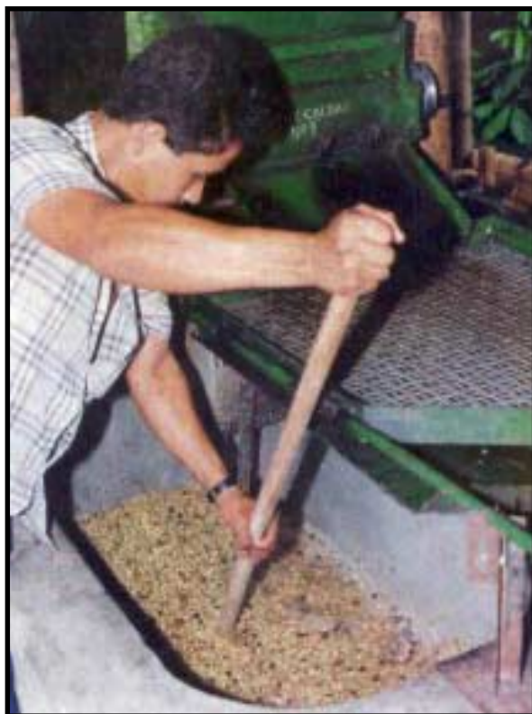
Lavado del café en el tanque tina de un beneficiadero ecológico para pequeños caficultores. Cenicafé.
