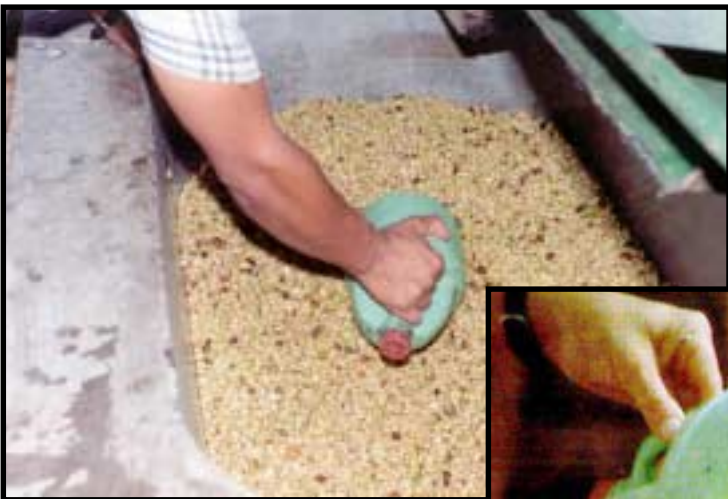
Figura 10. Descarga del tanque tina con un recipiente plástico perforado.
